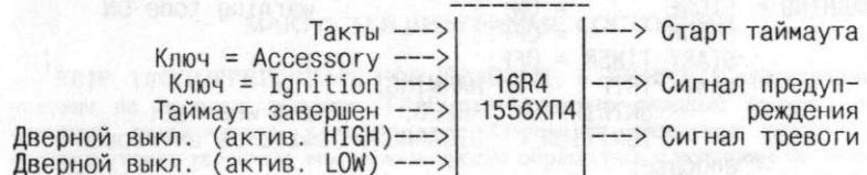
Упрощенная схема показана ниже. Заметим, что определены активными как низкий, так и высокий потенциалы сигналов, в зависимости от потребностей схемы.
